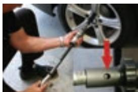
(2) UNIRE IL MARTELLO A MASSA BATTENTE ED APPLICARE FORZA FINO ALLA ROTTURA DEL BULLONE
