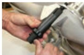
(1) AVVITARE SALDAMENTE L'ESTRATTORE REGOLABILE AL BULLONE
