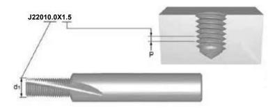
Dieser Gewindefräser kann für Gewinde ≥ M12x1,5 (M14x1,5, M18x1,5 usw.) eingesetzt werden.
