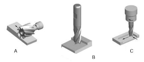
Nella fresatura periferica l'asse di rotazione della fresa è parallelo alla superficie in lavoro. La fresa è munita di una serie di denti disposti lungo la circonferenza, ogni dente agisce come un utensile da taglio a punta singola, definito fresa semplice. Le frese impiegate nella fresatura periferica possono essere dotate di denti diritti o elicoidali.
