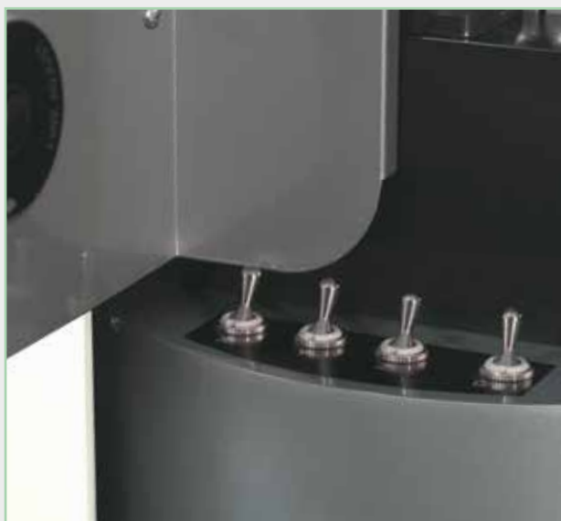
Gli assi X, Y e Z sono disinseribili singolarmente (macchina manuale). X, Y and Z axes can be locked individually (manual machine).
