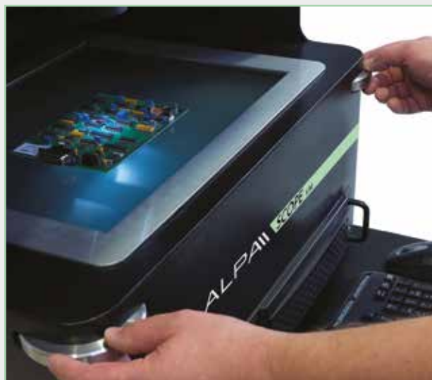
Volantini per movimento telecamera asse X e Y X and Y camera movement
