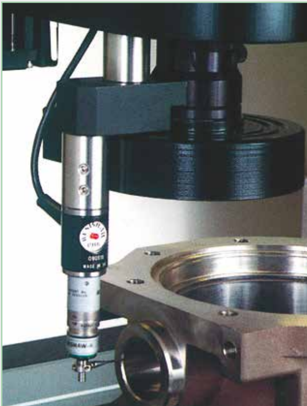
Tastatore a contatto Renisaw TP20 Renisaw TP20 touch probe
