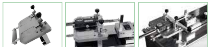
Controllo calibri di profondità. Control of depth calipers.
