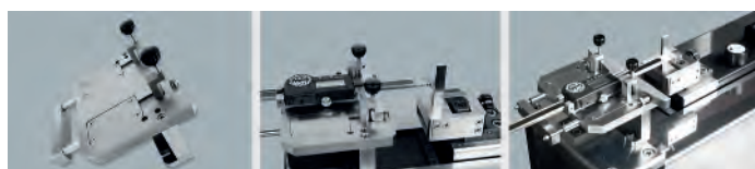
Controllo calibri di profondità / Control de calibres de profundidad
